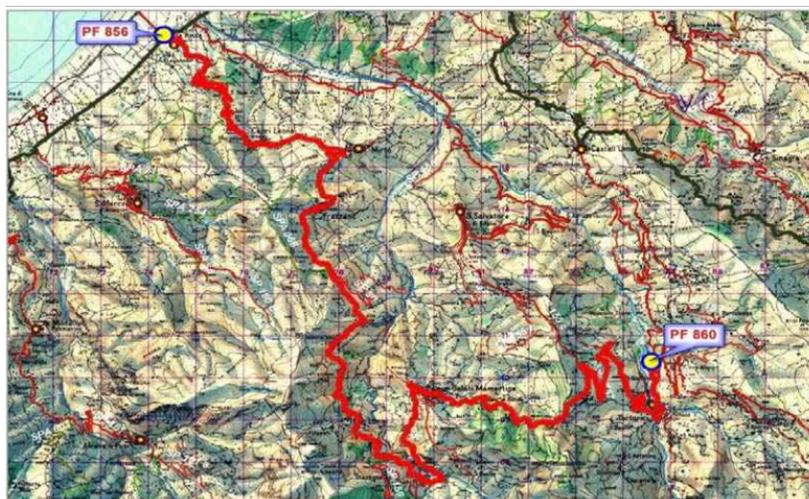
La strada ha inizio in corrispondenza del Km 112+400 della S.S. 113 e termina in corrispondenza della progressiva chilometrica 8+000 della S.P. 152 (Bivio Gentile), con un dislivello di m. 476 ed una pendenza media del 1,23%.
